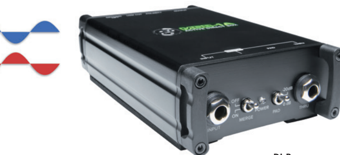
DI-Boxen symmetrieren das unsymmetrische Signal
